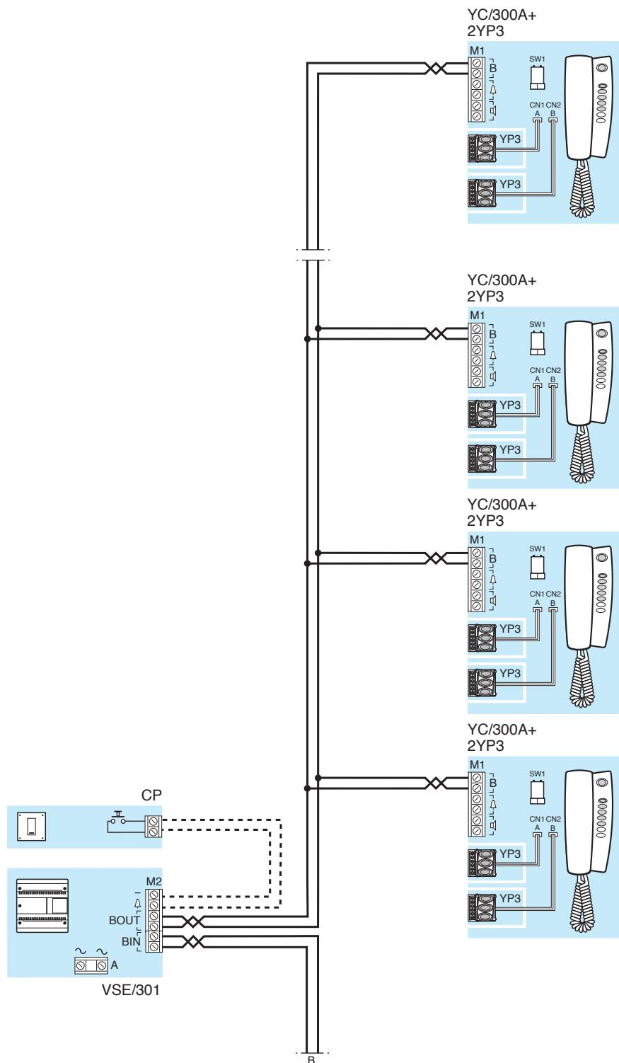
**Sezione di impianto videocitofonico (sistema X1) con 3 derivati interni intercomunicanti serie Lynea aventi unica chiamata dal posto esterno e attivazione del video sul derivato interno MASTER.**
