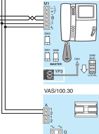
**Sezione di impianto videocitofonico (sistema X1) con monitor intercomunicanti (max.8) serie Ophera aventi unica chiamata dal posto esterno.**
